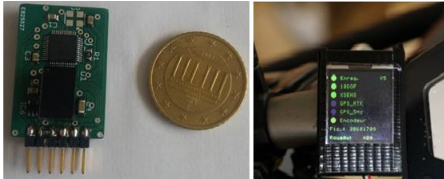
Figure 91. Nœud capteur Guidon, tours de roues (à gauche) et afficheur (à droite)
