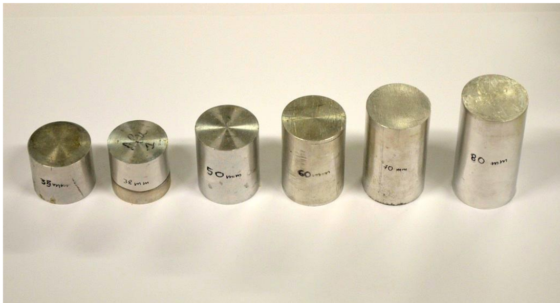
Figure 43: Six cylindres d'aluminium (longueurs L = 35\text{ mm} , 38\text{ mm} , 50\text{ mm} , 60\text{ mm} , 70\text{ mm} , et 80\text{ mm} de gauche à droite) fabriqués à partir d'un même bloc et utilisés pour mesurer précisément les vitesses des ondes S et P. Voir mesures figure 44.
