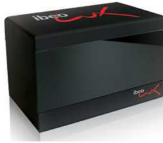
Laser scanner Ibeo Lux (automne 2008) taille 85x128x83mm 3
