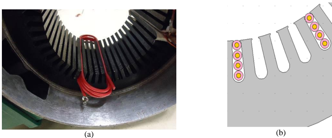
Figure IV.2 : (a) image de la bobine expérimentale disposée dans le stator (b) schéma descriptif de la disposition des conducteurs
