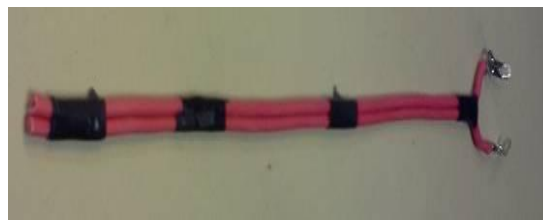
Figure IV.13 : schéma descriptif de la mesure de capacité entre deux conducteurs
