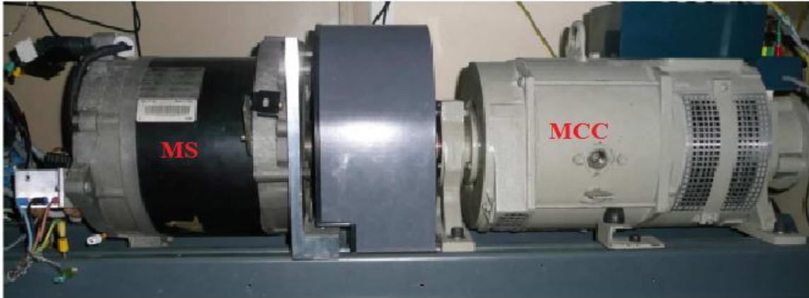
Figure II.8 : Banc expérimental de la machine synchrone (RENAULT KANGOO) accouplée à un moteur à courant continu
