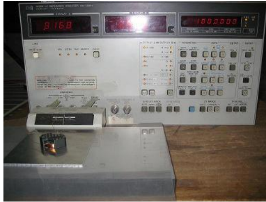
Figure 1.7 Analyseur d'impédance HP 4192A, capteur CF et structure testée.
