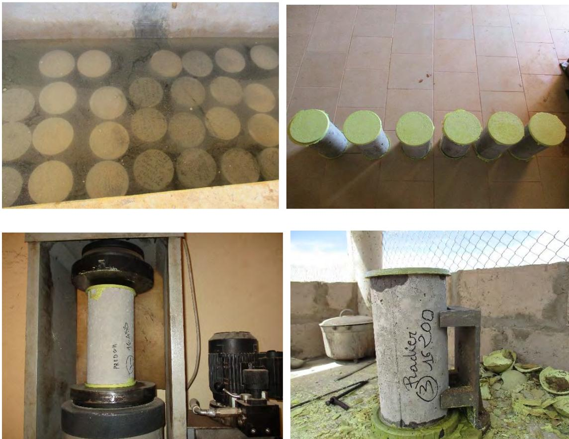
Bassin d'immersion des éprouvettes de béton et presse
