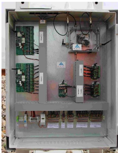
Figure II.12 – Cartes Pégase installées dans un coffret sur une section de la voie BPL
