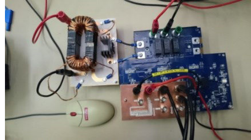
Figure 4-5 Photographie de la mise en œuvre expérimentale de l'onduleur à quasi Z-source avec une utilisation en pont H de l'onduleur branché sur une charge RL monophasée
