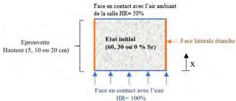
Figure IV-33 : Conditions initiales et aux limites pour les essais d'imbibition capillaire
