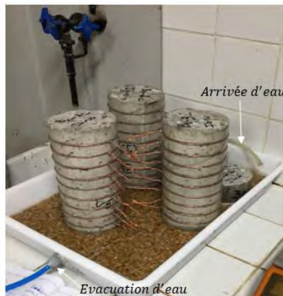
Figure II-30 : Dispositif expérimental pour le test d'imbibition capillaire montrant les éprouvettes testées et le système de trop-plein
