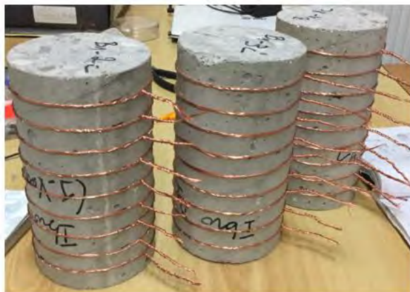
(a: Mise en place des anneaux de cuivre)
