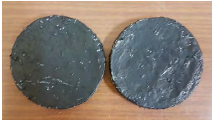
Figure II-13 : Caoutchouc enrobé de peinture conductrice
