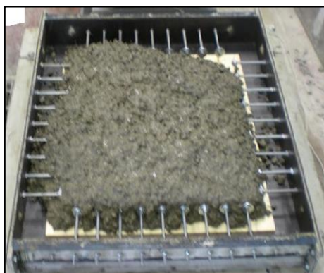
Figure IV-7: Exemple d'essais avec des tiges localisés au bord et au fond des moules (Choi et al., 2014; Ruiz-Ripoll et al., 2013)
