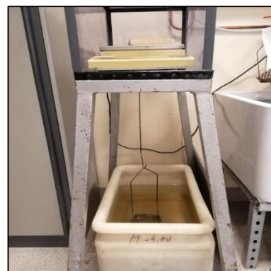
Figure II-26: Système de pesée hydrostatique
