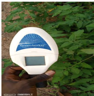
Photo 13 : Appareil de mesure de la vigueur (GreenSeeker)
