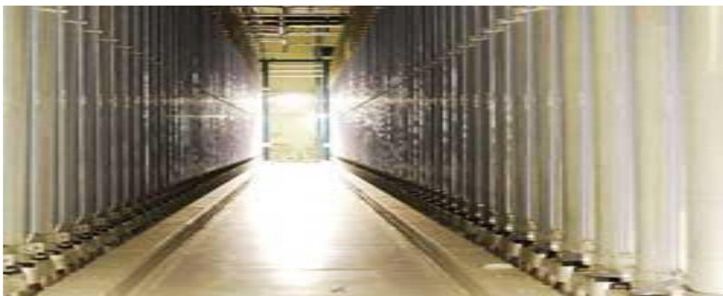
Figure 4 : Cascades de centrifugeuses
