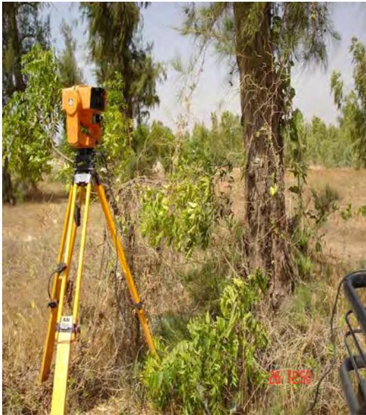
**A. Mise en position du géodimètre**
