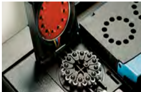
Figure : 13 Couronne chargée dans le module d'amplification.
