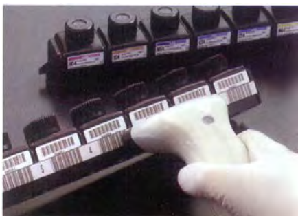
Figure:14 Identification par code barre des cassettes.
