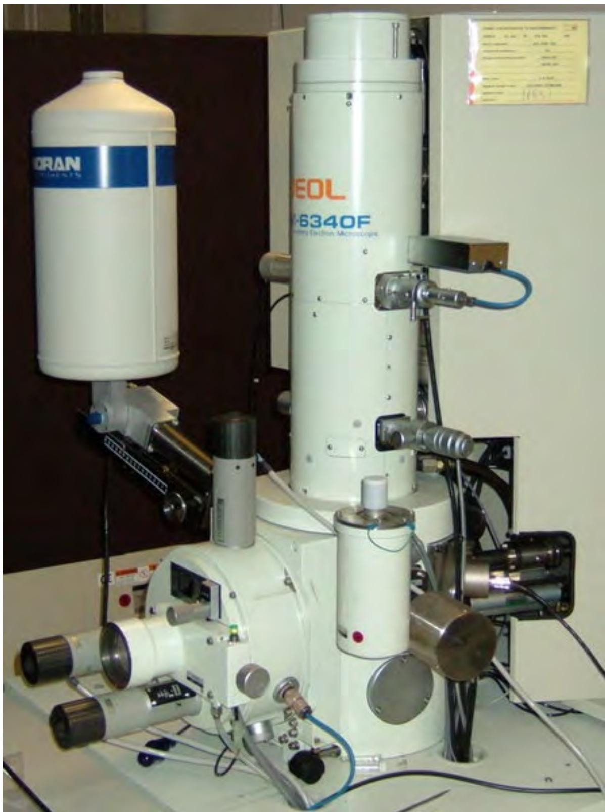
Microscope électronique à balayage
