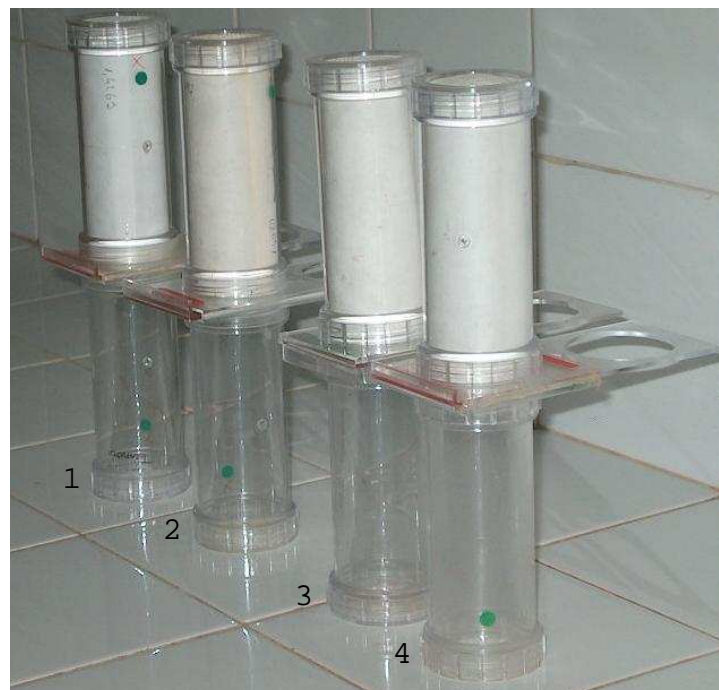
Figure 7 : Test de sensibilité au LBPP : (de gauche à droite) tube n°1=témoin; n°2=0,5 mg/cm 2 , n°3=1 mg/cm 2 et n°4=2,5 mg/cm 2
