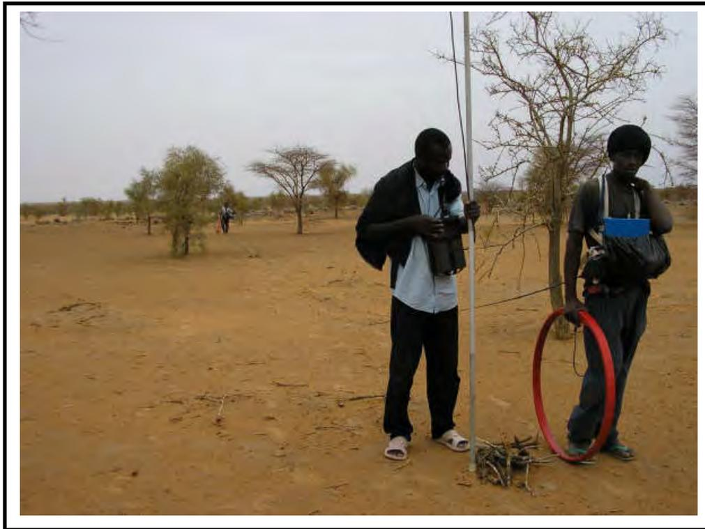
Figure 28 : Dispositif de la méthode Electromagnétique
