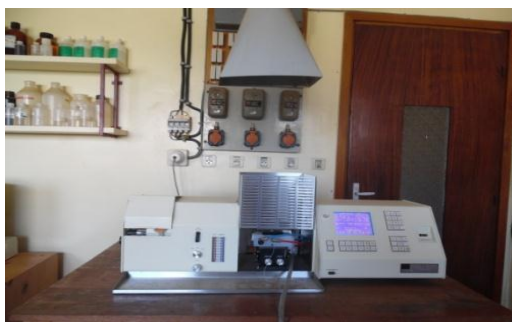
Figure 19 : Spectromètre d'absorption atomique
