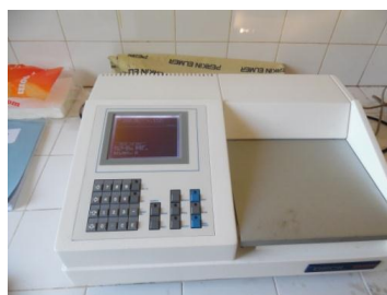
Figure 18 : Spectromètre UV/VIS à la longueur d'onde de 660 nm
