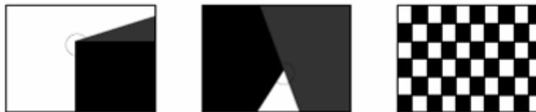
**Figure 4** : Différents types de points d'intérêt : coins, jonction en T et point de fortes variations de texture. [1]
