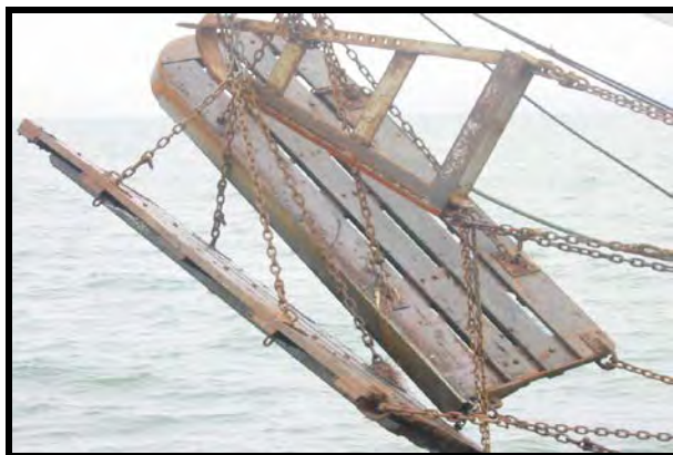
Figure 25: Panneaux en bois avec fente de type plat (source MAP, 2006)
