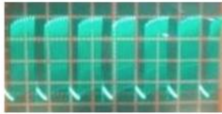
Figure 3.1: Le train d'ondes de Meyer mesuré au niveau de la cellule WFC [3]
