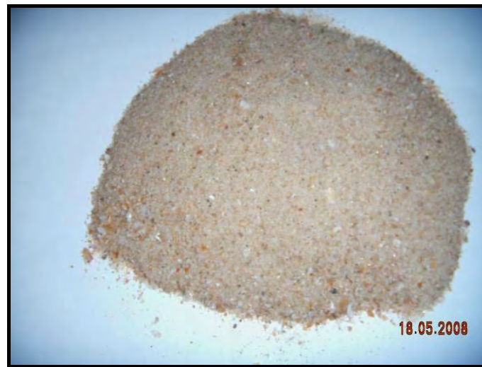
Photo 5 : Sable de mer utilisé comme filtre sur les lits.
