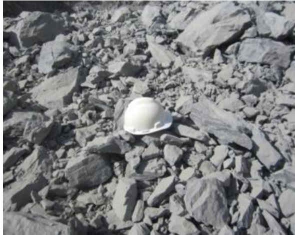
Fig. IV.12: Exemple des résultats visuels de la fragmentation (Amesmessa tir A 2015)
