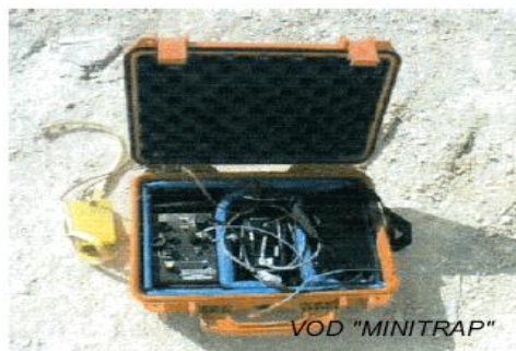
Fig. I.20: Appareil de mesure directe de la vitesse de détonation en place
