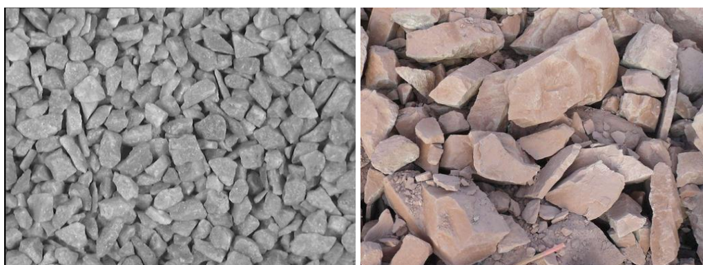
Fig. III.7: Bonnes pratiques d'échantillonnage (LxH = 768x576 pixels) (a) Granulat 4-6 (0,2 mm/pixel) (b) Tas abattu (4 mm/pixel)
