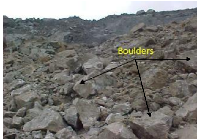
Fig. II.5: Comptage des hors-gabarits dans le profil du tas abattu des roches
