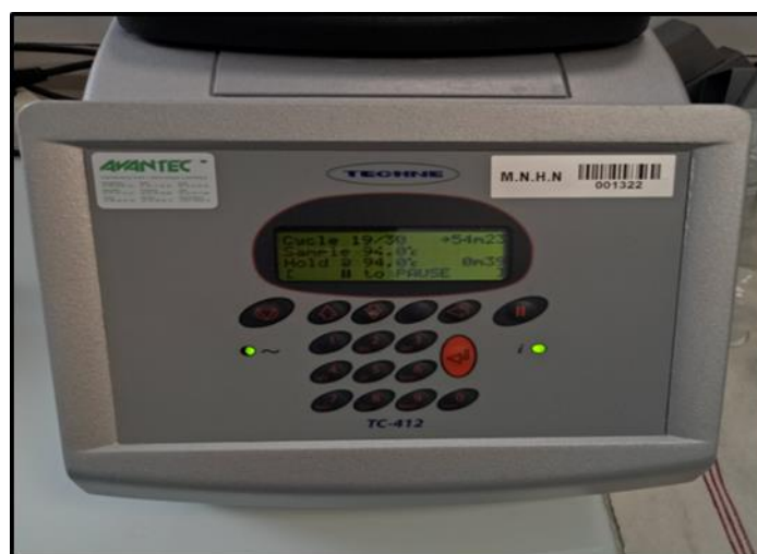
Figure 30: Thermocycleur automatisant la réaction de PCR, (Photo personnelle, 2018).
