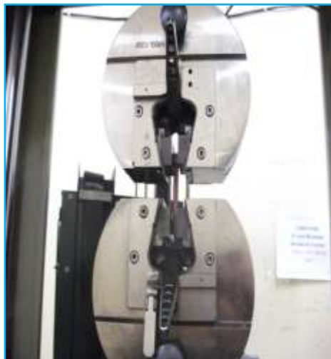
Figure II.26: Dispositif de montage et d'amarrage des éprouvettes sur la machine universelle MFL de type VHP 600.
