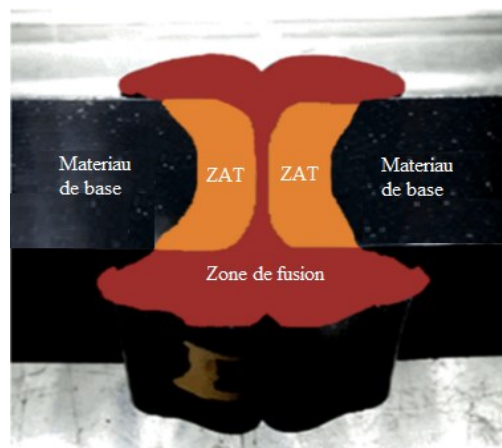
Figure 1.12 : Schéma représentatif du MZ et HAZ dans une soudure b-à-b [27]
