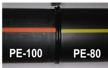
Figure 1.15: Soudure bout à bout des deux résines PE80/PE100 [28]
