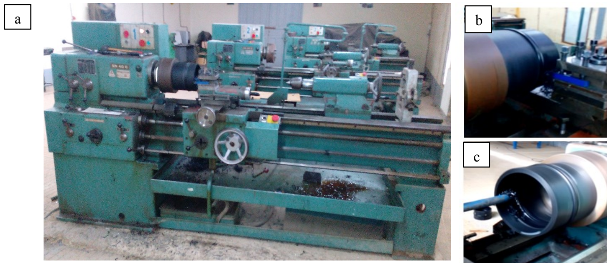
Figure 2.2 : Opération d'usinage des enveloppes soudés et non soudés. a) Machine de tour TOS TENCIN, modèle SN 40 b) Tournage, c) Alésage
