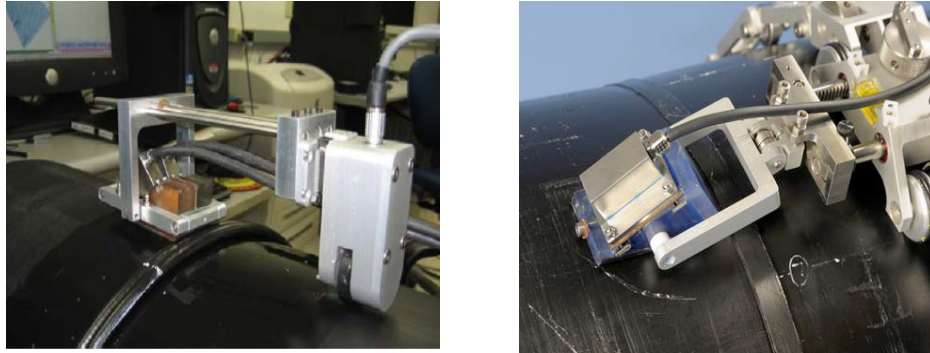
Figure 1.20 : Technique de contrôle par ultrason [39]
