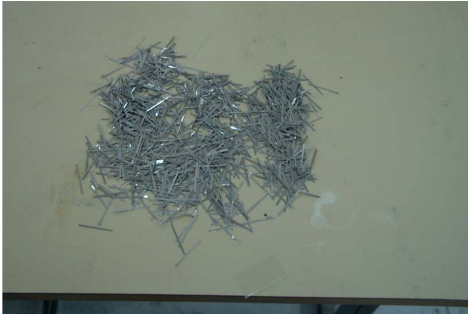
Photo III-1 : Fibres métalliques types fonte amorphe
