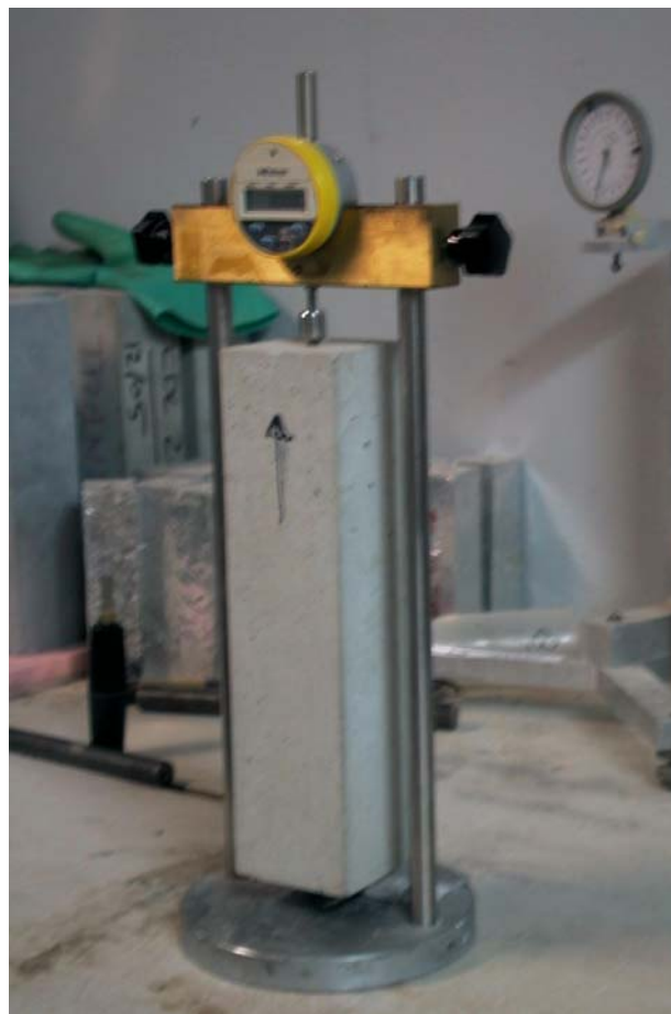
Figure V-4 : Appareil de mesure de retrait
