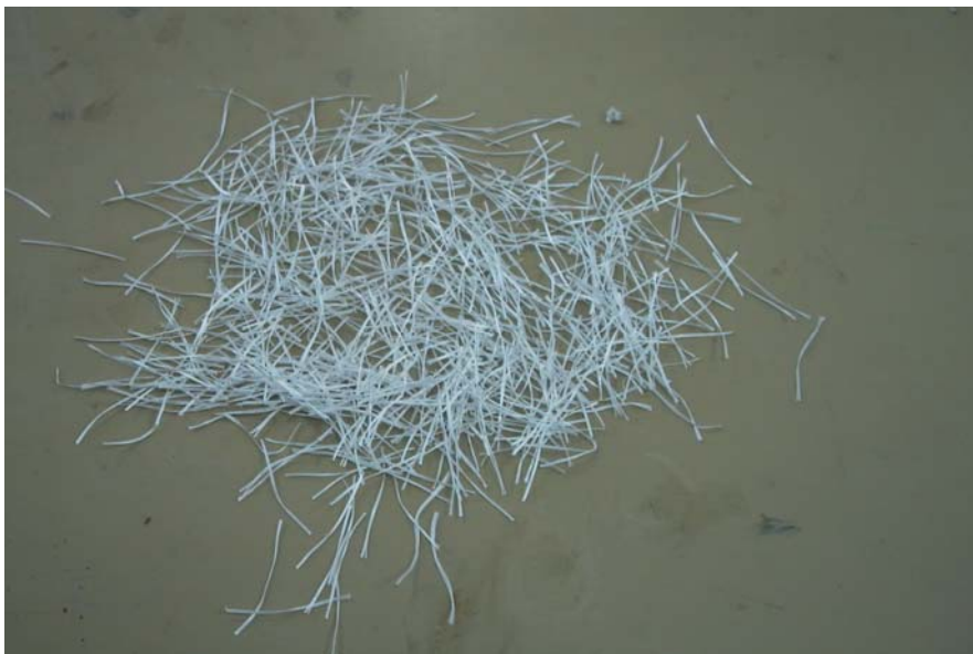
Photo III-2 : Fibres synthétiques type structural (GRACE)
