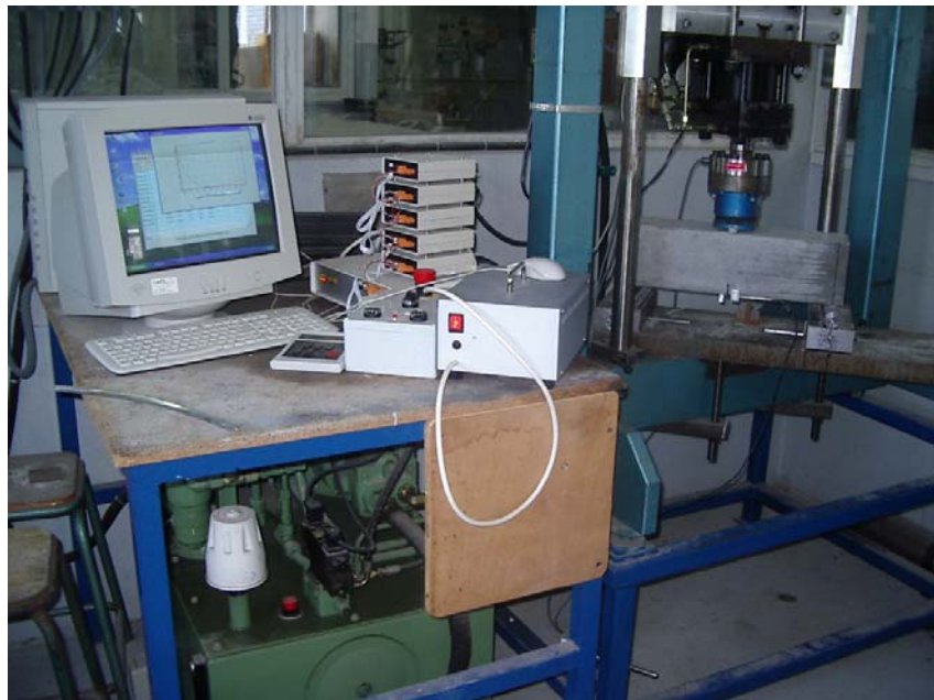
FigIV-7: Eléments du dispositif de flexion 03 points
