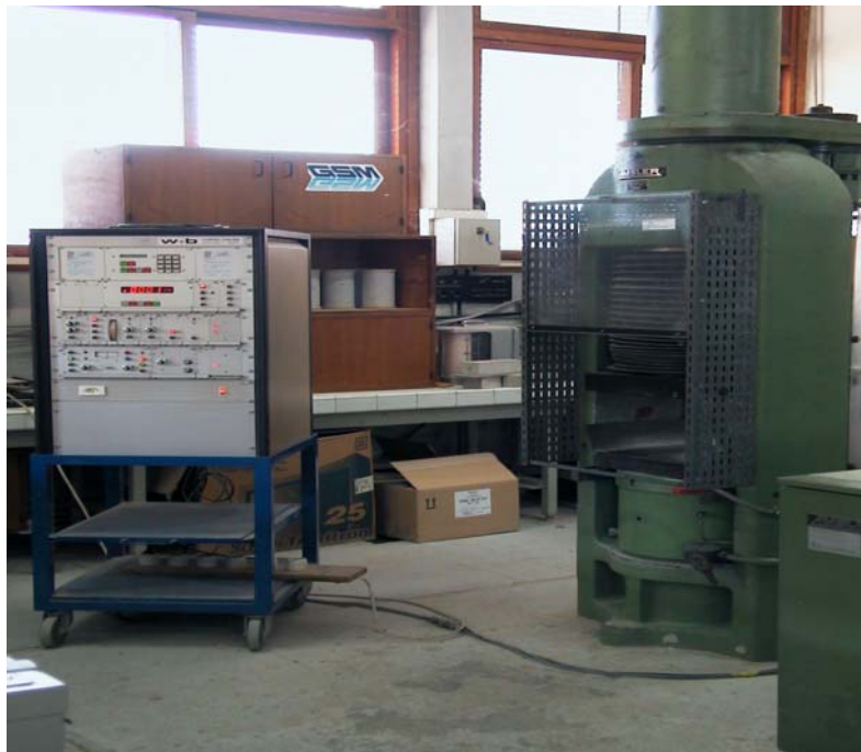
Photo IV-1 : Presse utilisée pour les essais de compression et traction par fendage
