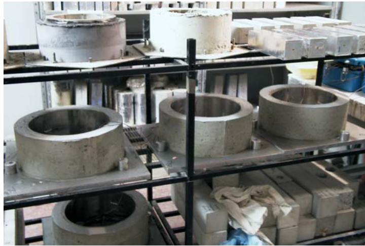
Figure V-7-2 : Eprouvates dans la salle de retrait
