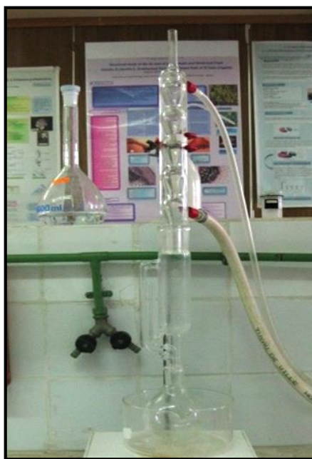
Figure 19 : photo présentant l'appareil de soxhlet (Messioughi, 2010).
