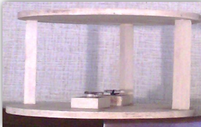
Figure 21 : Le dispositif d'échantillonnage de Durham (1946) (Photo Necib, 2012)
