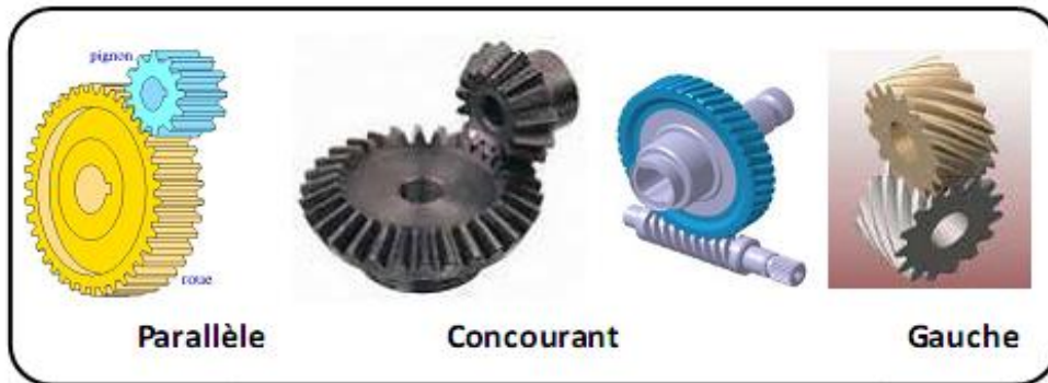
Fig. II.7. Différents types d'engrenage [45]
