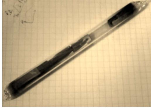
Figure II. 4. Photo montrant des échantillons Al-Mn introduits dans un tube de quartz.
