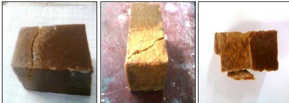
*Figure 3.22. Mode de rupture des éprouvettes en compression.*
