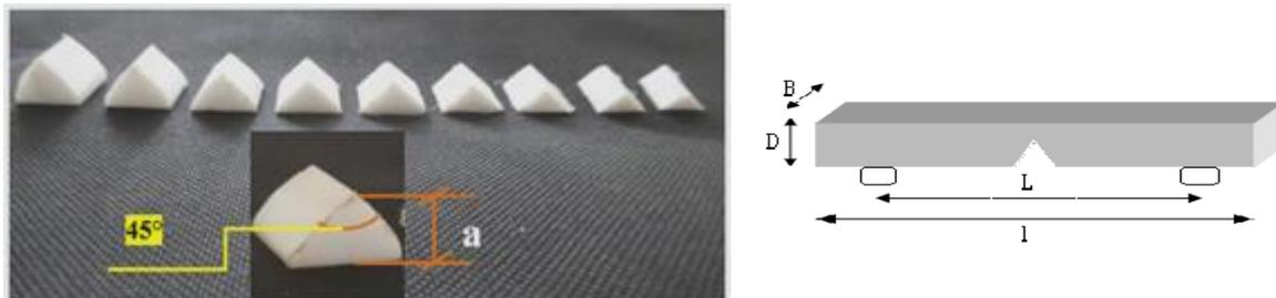
Figure 2.15. Téflon utilisé dans l'éprouvette de choc Charpy.
