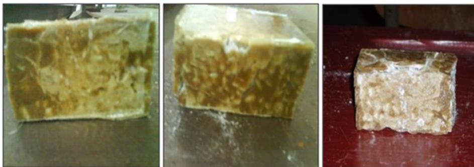
*Figure 3.32. Mode de rupture des éprouvettes en compression.*
