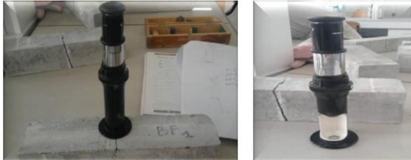
*Figure 7.2. Mesure d'ouverture à l'aide d'un fissuromètre.*
