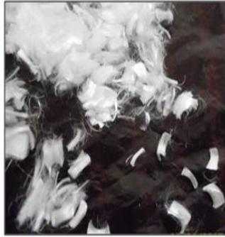
*Figure 2.6. Fibre de polypropylène.*
