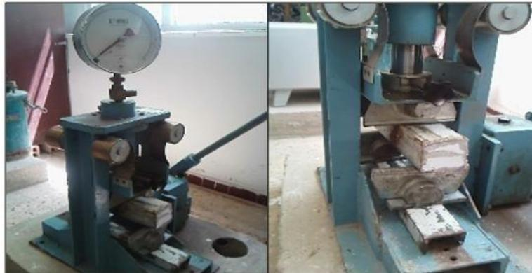
*Figure 7.11. Dispositif d'essai de traction par flexion 4 points.*
