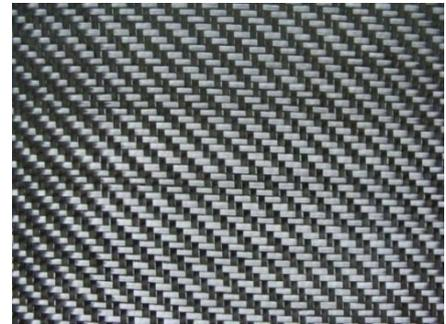
*Figure 1.4. Fibre de carbone [36].*
