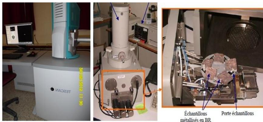
*Figure 2.18. Microscope électronique à balayage et porte échantillons.*
