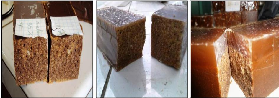
*Figure 3.21. Mode de rupture des éprouvettes en flexion.*
