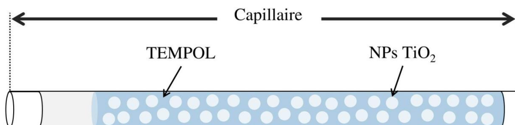
Figure III.15: Schéma d'un capillaire rempli par la suspension NPs \text{TiO}_2 / TEMPOL et scellé aux deux extrémités.
