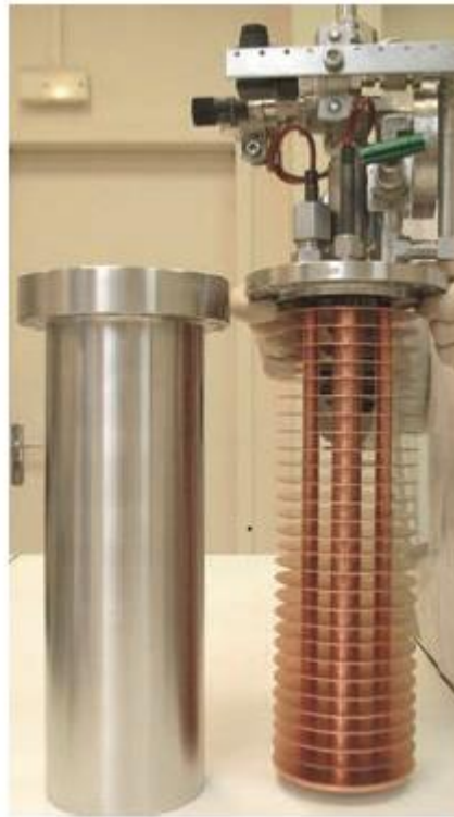
Figure 2. 12: assemblage des disques d'hydrure de magnésium [78]
