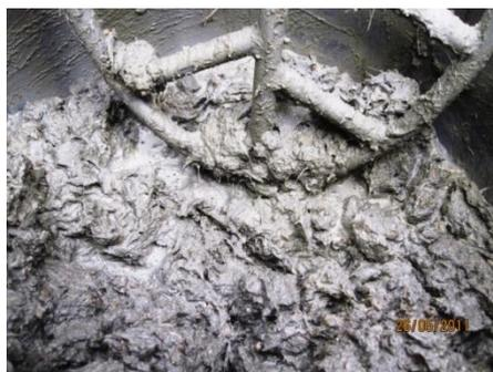
**Figure 4.3** Composite fibré (JFC2) à l'état frais pendant le malaxage.
