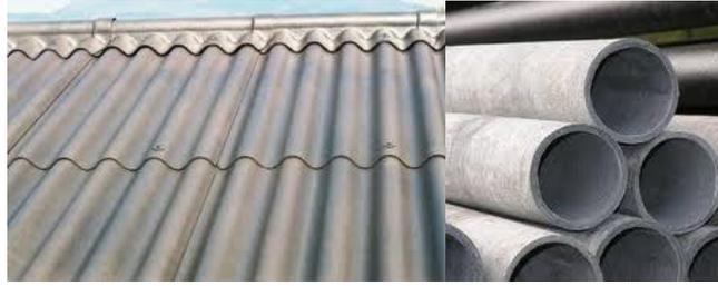
**Figure 1.25,** Tôles ondulées et tuyaux en amiante/ciment
