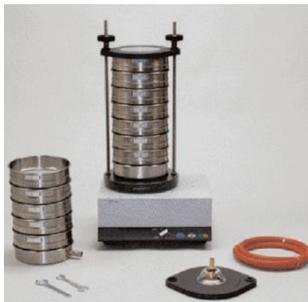
Elle s'applique à tous les granulats de dimensions nominales inférieures ou égales à 63 mm, à l'exclusion des fillers. L'essai [50] consiste à classer les différents grains constituant l'échantillon en utilisant une série de tamis emboîtés les uns sur les autres, dont les dimensions des ouvertures normalisées sont décroissantes du haut vers le bas (figure 2.5).
