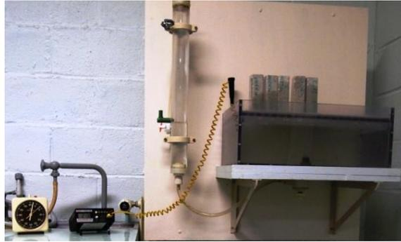
**Figure 2.34** : Montage expérimental pour l'essai d'imbibition capillaire
