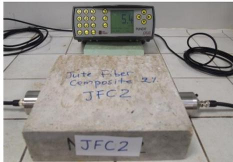
**Figure 2.27** Photo de l'appareil Ultrasonic Tester PUNDIT 7
