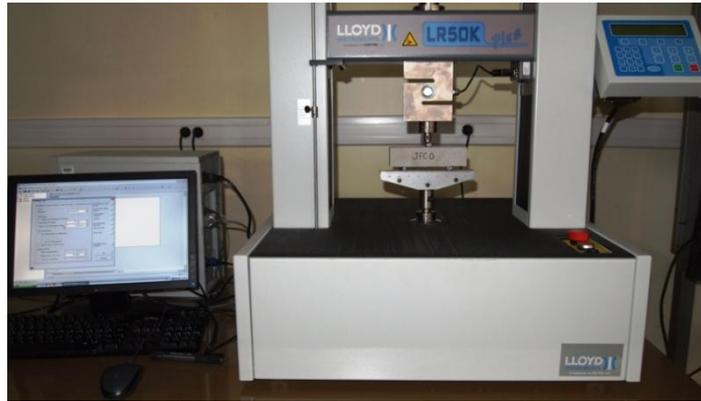
**Figure 2.38** : Machine utilisée pour l'essai de flexion charge-déplacement
