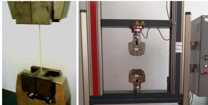
**Figure 2.14** Essai de traction sur un fil de tissu de jute.
