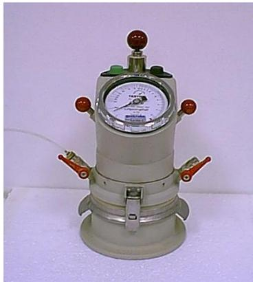
**Figure 2.25** Photo de l'aéromètre à mortier
