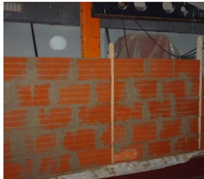
**Figure 2.9** Photo des murets sans enduit.
