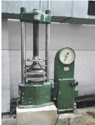
**Figure 2.3** Machine d'essai de compression (Presse hydraulique LGC. UBMA)
