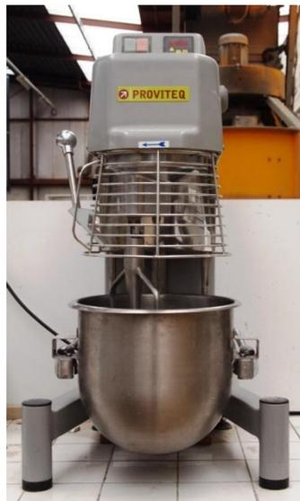
**Figure2.24** Malaxeur ayant servi à l'élaboration des échantillons.
