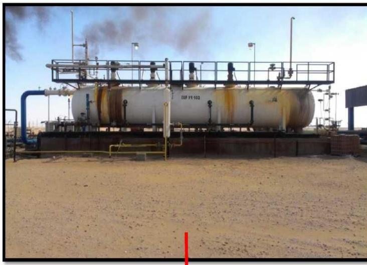
**Figure (IV.27) :** Le Séparateur de flottation à gaz induit (IGF).
