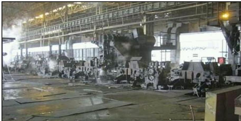
Fig. 75 : Train de laminage.
