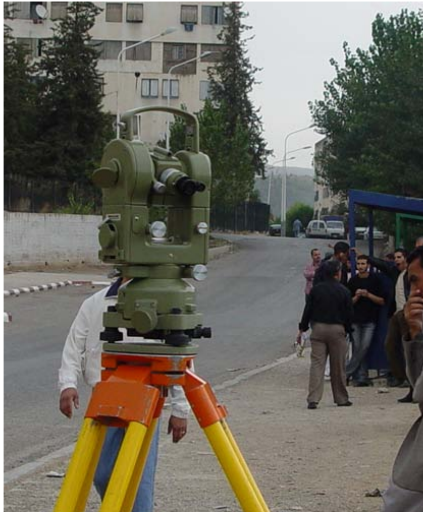
Fig. 20 : Instrument topographique T2 Universel WILD avec lecture angulaire micrométrique à (0.0001 grade).
