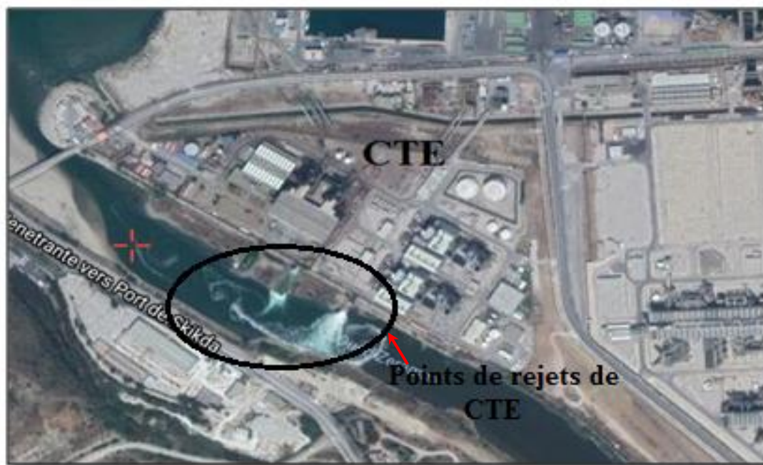
Figure 10: Image satellitaire montrant la centrale thermique CTE du Complexe pétrochimique de Skikda et ses 3 principaux points de rejets dans l'oued Saf saf (cercle noir) (Google earth, 2018 modifiée).
