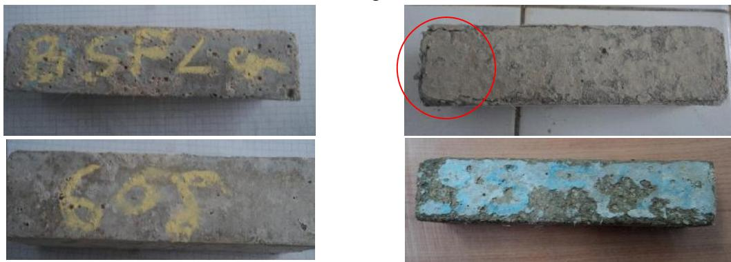
**Figure IV.51-** Dégradation visuelle des bétons de sable à base avec fillers calcaire conservés dans le  $\text{MgSO}_4$
