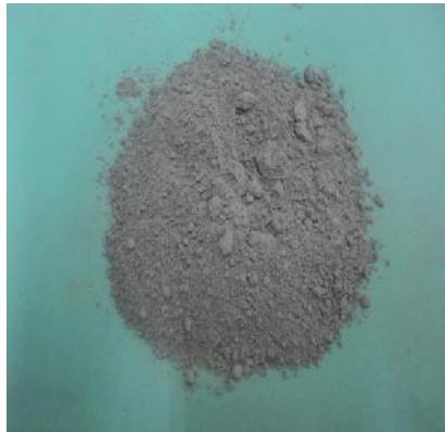
**Figure II-9:** Fillers de laitier granulé
