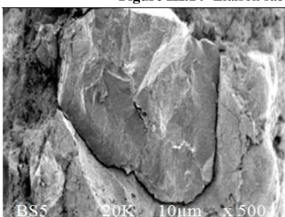
**Figure III.15-** Liaison sable de carrière - matrice cimentaire
