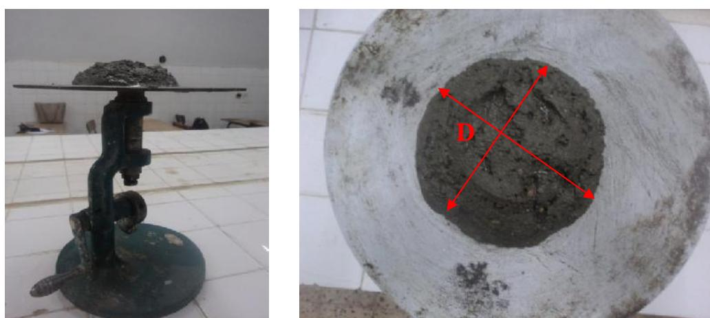
**Figure II-20:** Essai d'étalement à la table à secousses
