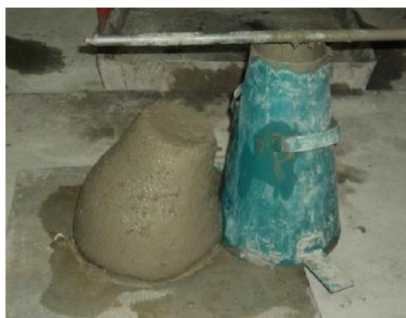
**Figure II-19:** Essai d'affaissement cône d'Abra.ms
