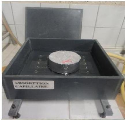
A/ Dispositif expérimental pour l'essai d'absorption capillaire
