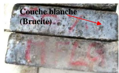
**Figure IV.49-** Dégradation visuelle des mortiers à base de laitier granulé conservés dans le  $MgSO_4$
