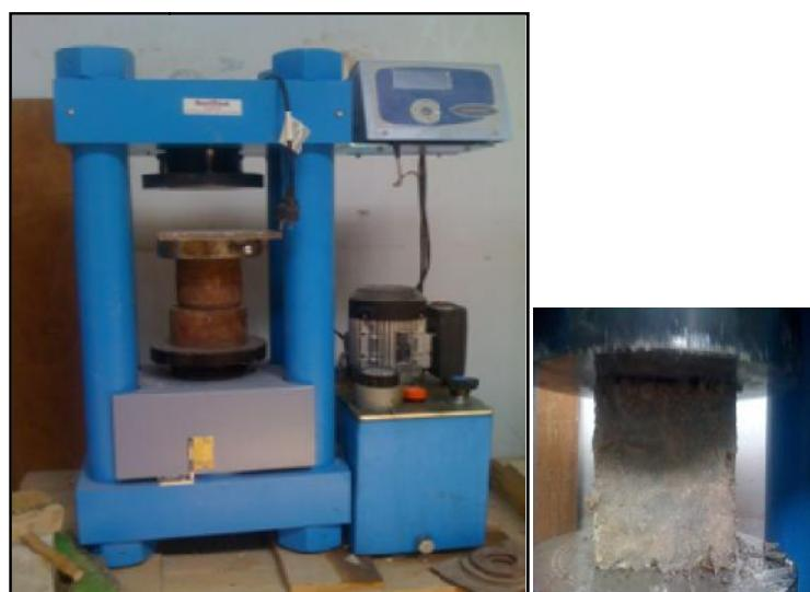
**Figure III.1-** Description d'essai de compression
