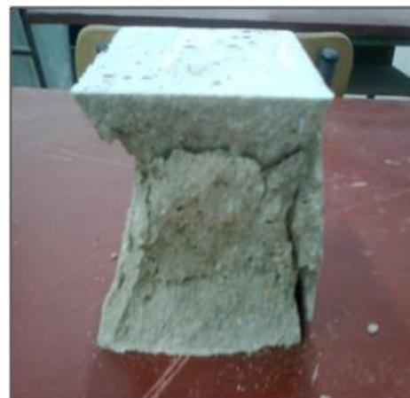
**Figure III.12-** Mode de rupture des bétons de sable sans fibres
