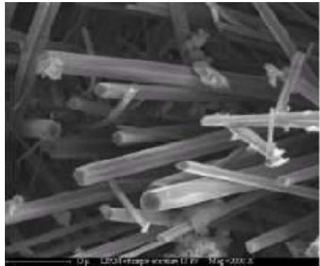
**Figure I.3-** Observation au Microscopie Electronique à Balayage d'ettringite. [GCI, 2008]
