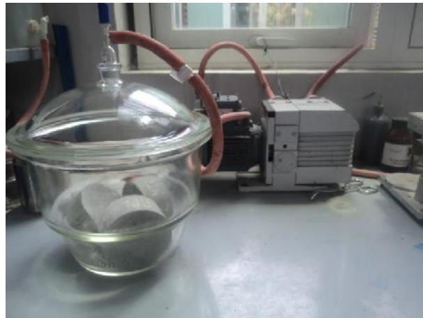
**Figure IV.6-** Dessiccateur à vide pour le dégazage des échantillons
