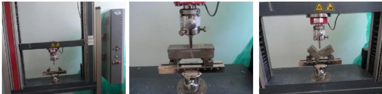
**Figure III.2-** Description d'essai de traction par flexion
