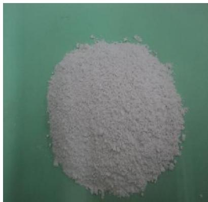
**Figure II-12:** Fillers calcaire
