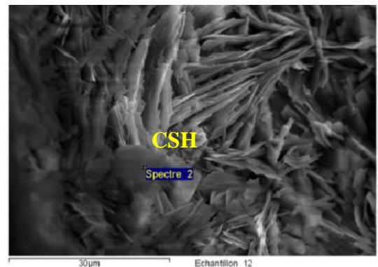
**Figure IV.61-**Mortier avec addition de laitier granulé conservé dans le MgSO<sub>4</sub> après démolage / cœur de l'éprouvette
