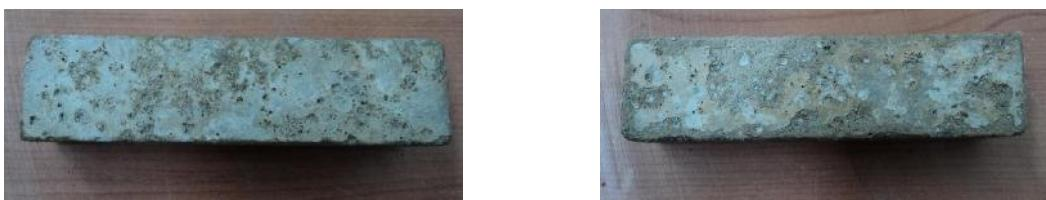
**Figure IV.52-** Dégradation visuelle des bétons de sable à base avec laitier granulé conservés dans le  $\text{MgSO}_4$
