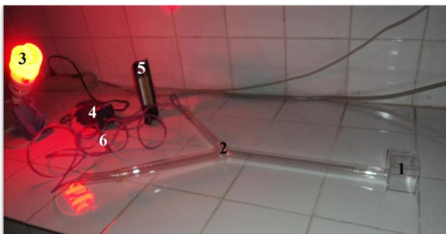
Figure 12. Tube en forme de « Y » olfactomètre bidirectionnel
