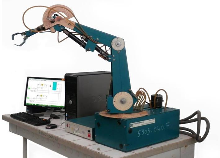
Figure IV.10 : Robot manipulateur hydraulique FEEDBACK HRA934
