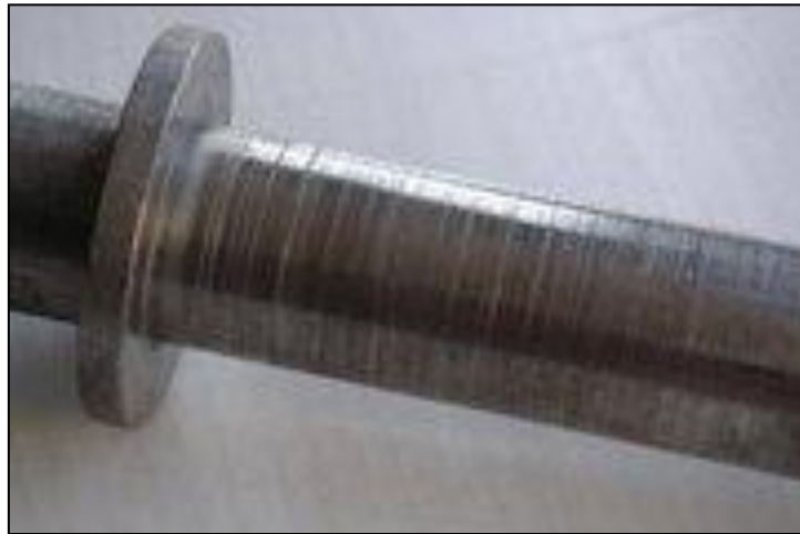
Figure I.39. Forme d'usure par abrasion sur un tourillon [39]
