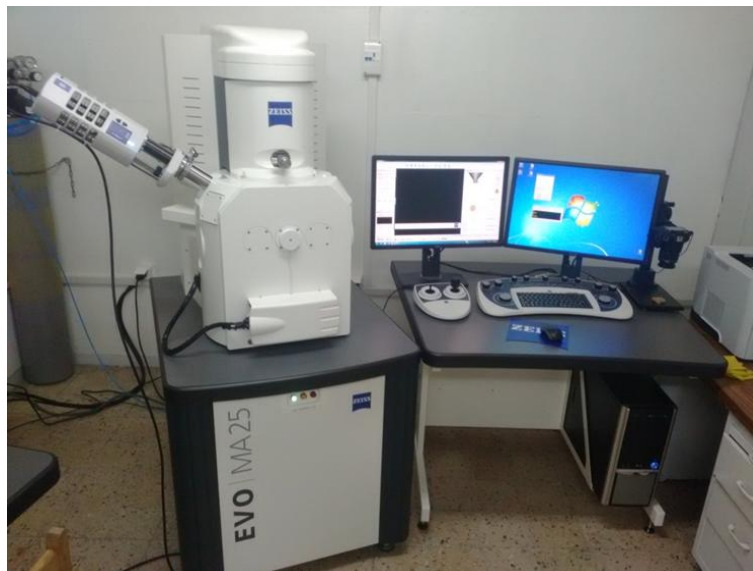
Figure II.4. Microscope électronique à balayage type EVO MA 25(X 1 000 000)
