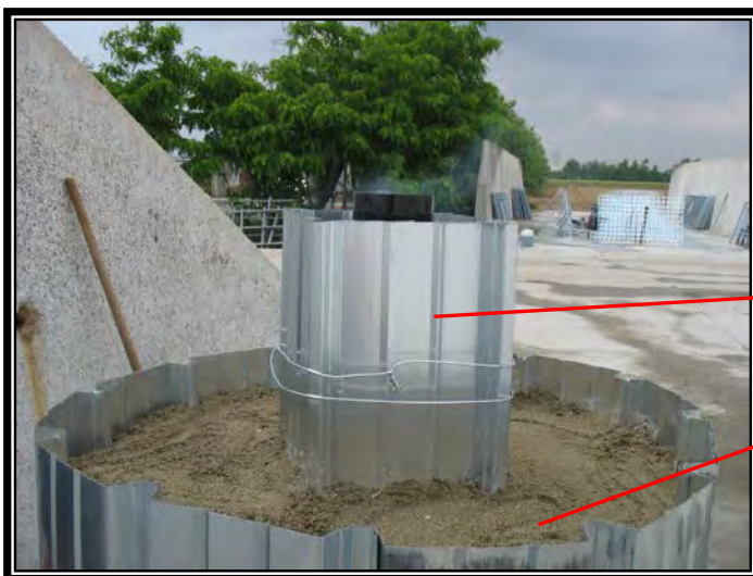
Fig. 2.15 – vue du four complètement fermé durant un test de calcination
