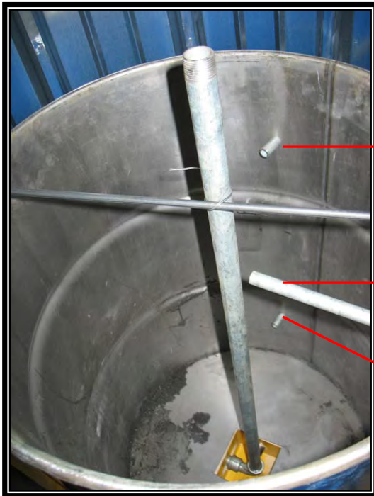
Fig. 2.8 – tube pour l'introduction de la sonde de température
