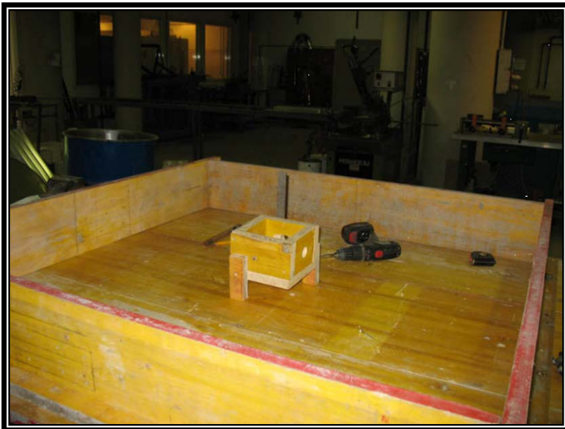
Fig. 2.1 – positionnement de la petite caisse au centre du caisson, à une hauteur de 5 cm par rapport au fond
