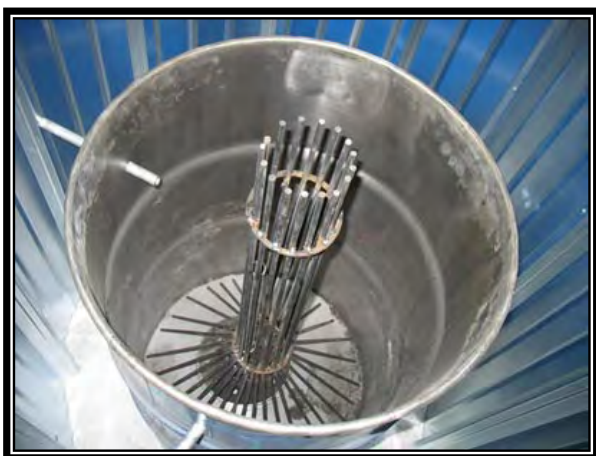
Fig. 2.12 - positionnement de la grille de séparation charbon/os à l'intérieur du baril d'huile
