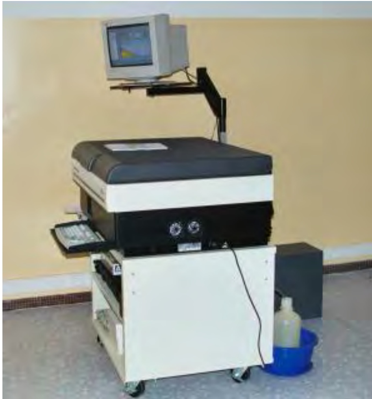
Photo : Spectromètre-analyseur à scintillation liquide Tricard 3170 TR/SL installé dans la salle Théodore Monod du Laboratoire par le Radiocarbone de Dakar
