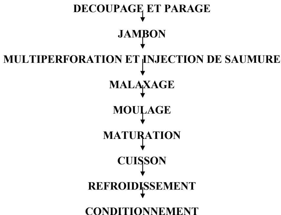
Figure 5 : Diagramme de fabrication du jambon cuit (Foret, 2011)
