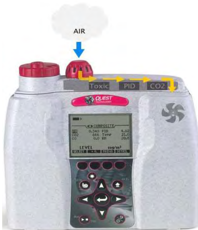
Figure 5: Capteurs de gaz et cheminement de l'air
