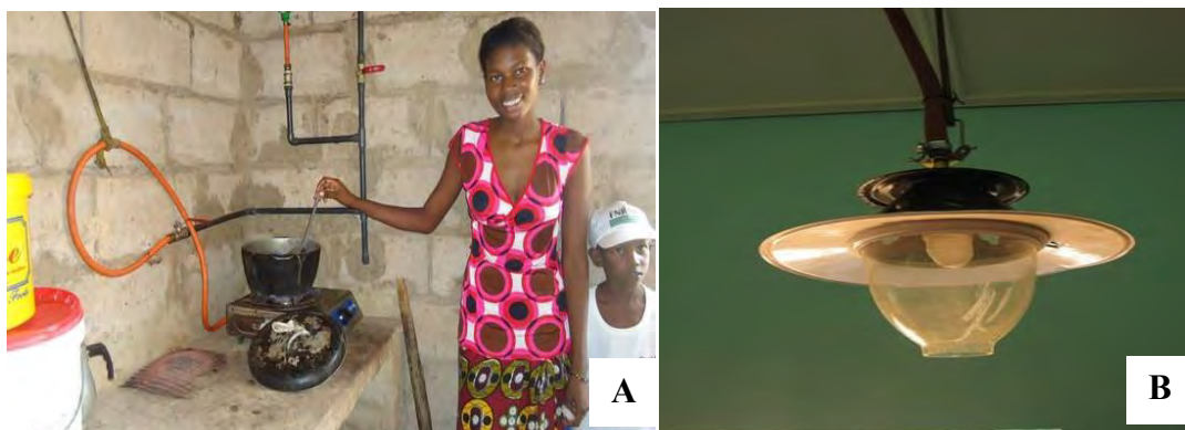
Figure 3. Utilisation de l'énergie issue du biodigester domestique ; A. Cuisson avec double Foyer à biogaz ; B : Eclairage avec lampe à biogaz
