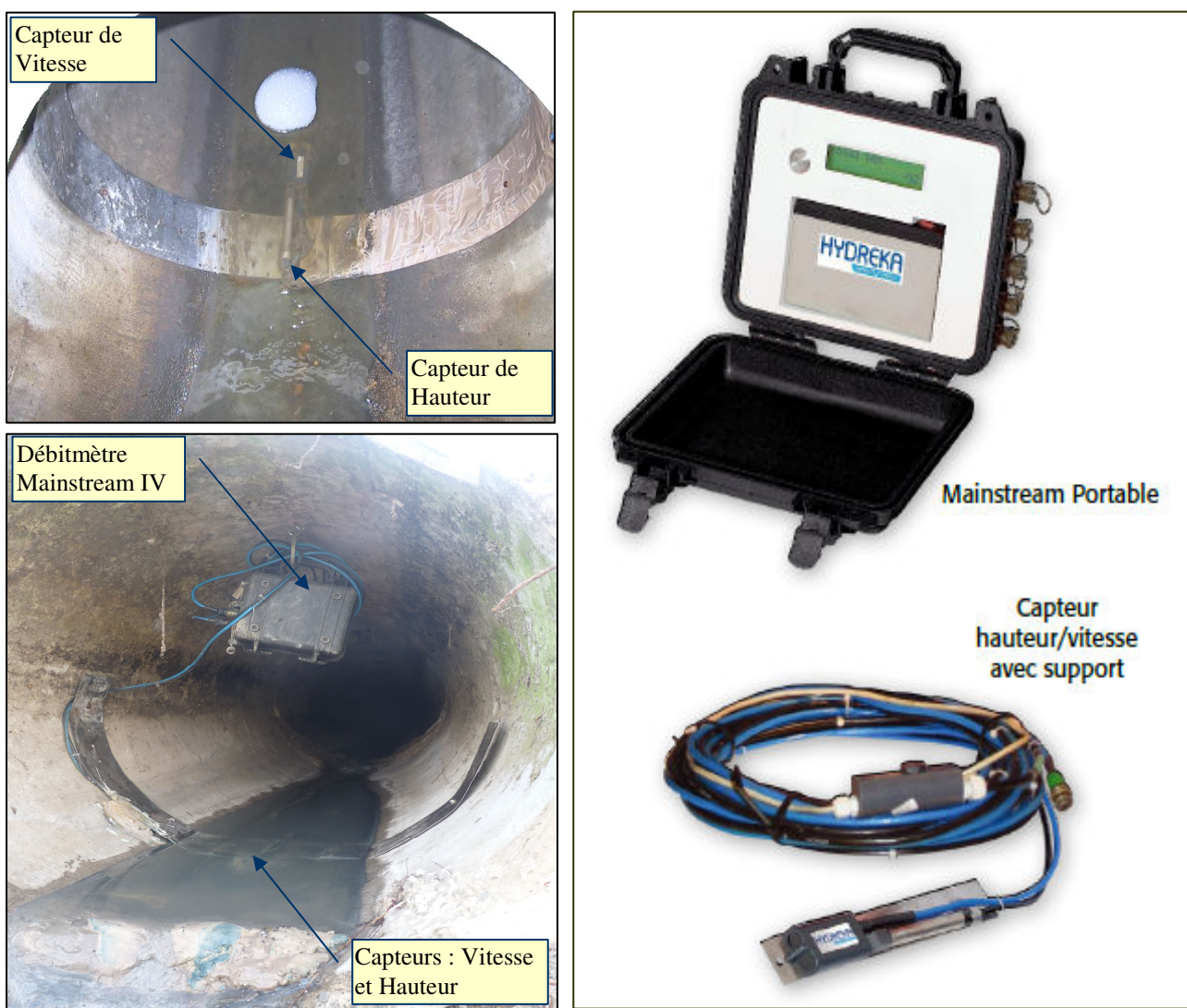
Figure 16 : Débitmètre à effets doppler –MAINSTREAM
