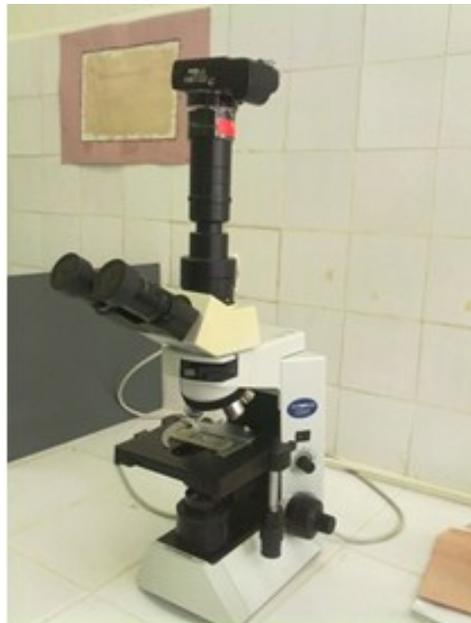
**Figure 26 :** Microscope à polarisation avec cellule de malassez et dispositif de photographie
